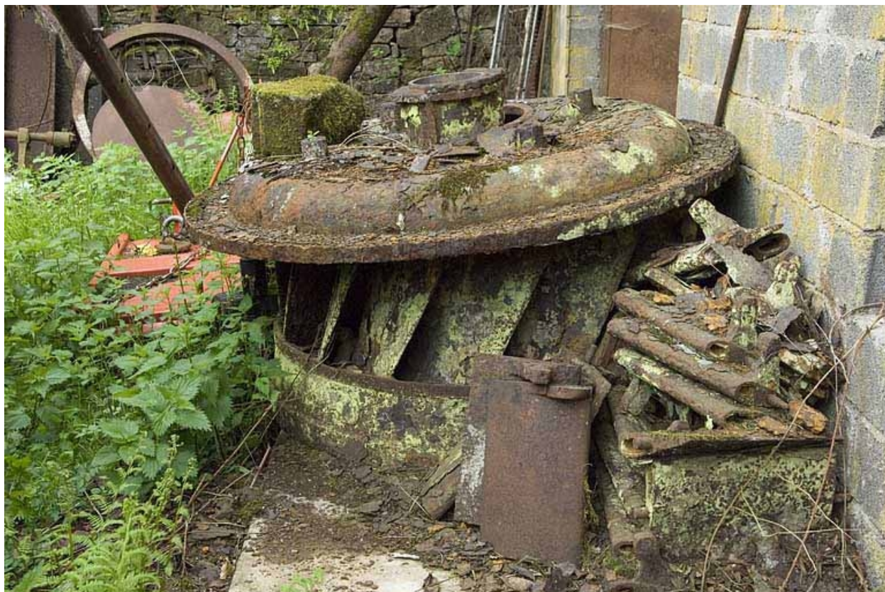
Vestiges d'une turbine Francis.
