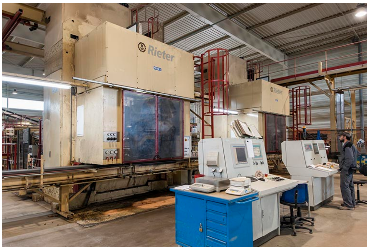
Unité de fabrication dite UL 5. Presses Rieter.
