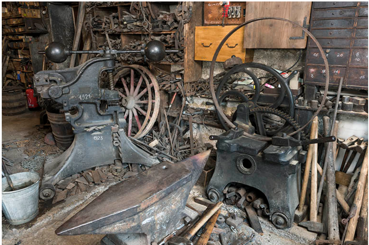
Forge : enclume, cisaille à balancier A. Vernet (Dijon) et refouleuse Jules Groperrin (Besançon).
