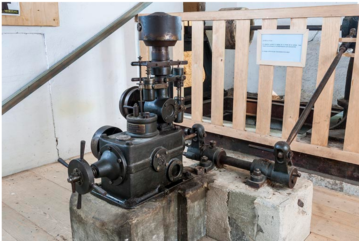
Rez-de-chaussée. Régulateur (SACM) de la turbine Laurent et Collot.
