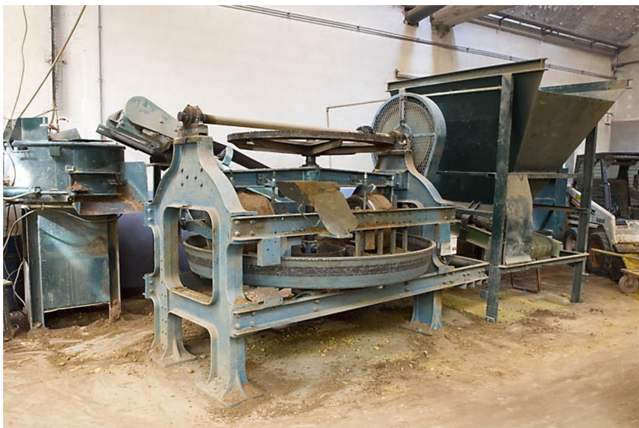
Malaxeur (préparation du sable pour les moules).
