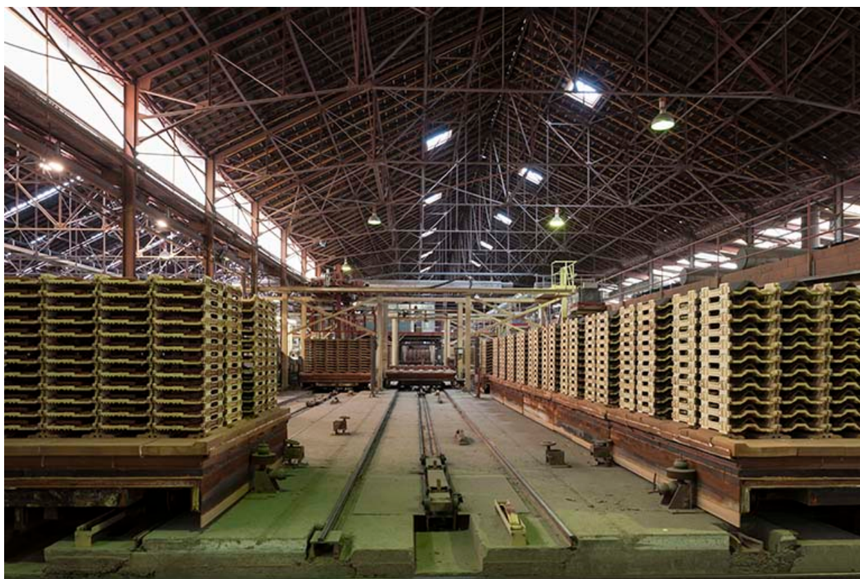
Tuilerie et briqueterie Migeon, à Lantenne-Vertière : unité de fabrication UL 1. Chariots de four.
