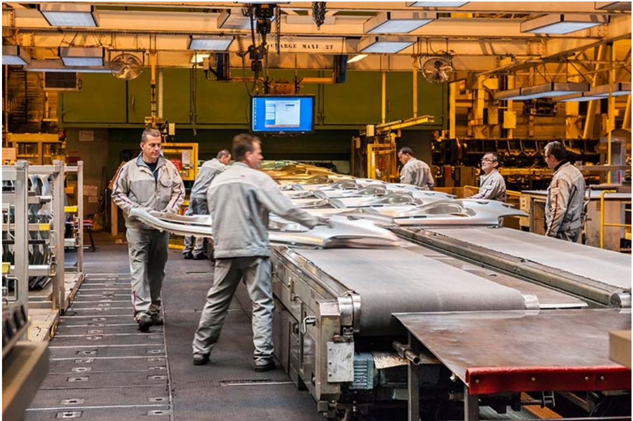
Automobile : usine Peugeot à Sochaux, atelier d'emboutissage, opérateurs en sortie de presse.
