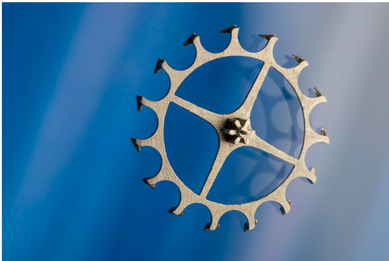
Echappement à cylindre : roue de cylindre, côté pignon.
