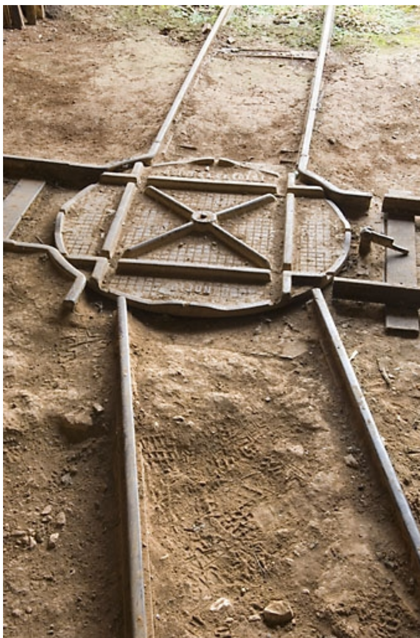
Voie système Decauville. Plaque tournante Pétolet.
