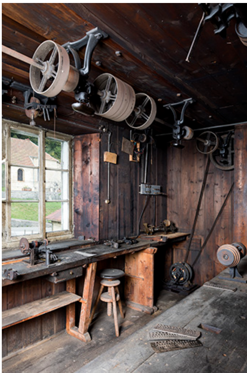
L'atelier, avec moteur électrique et transmissions.
