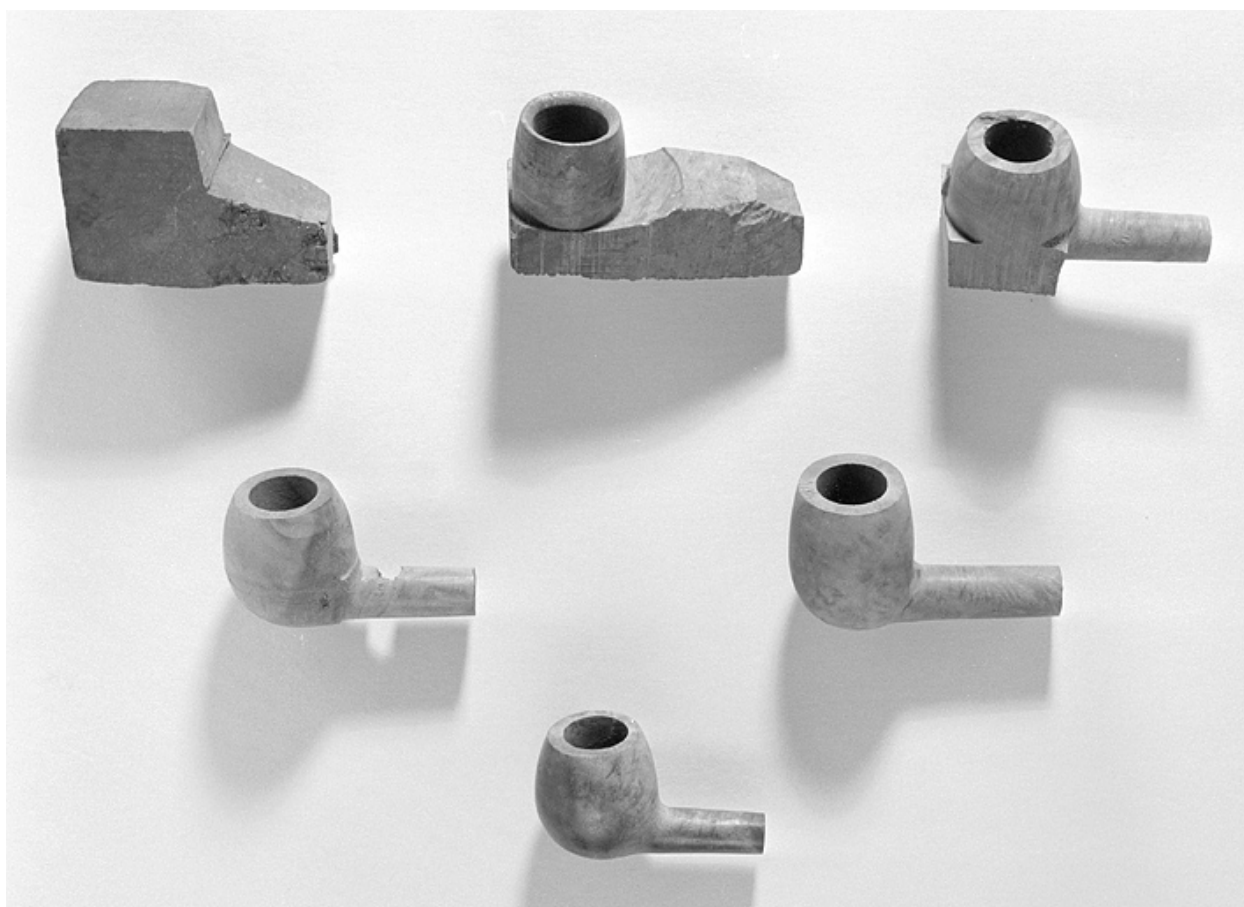
Les différentes phases de fabrication d'une pipe.
