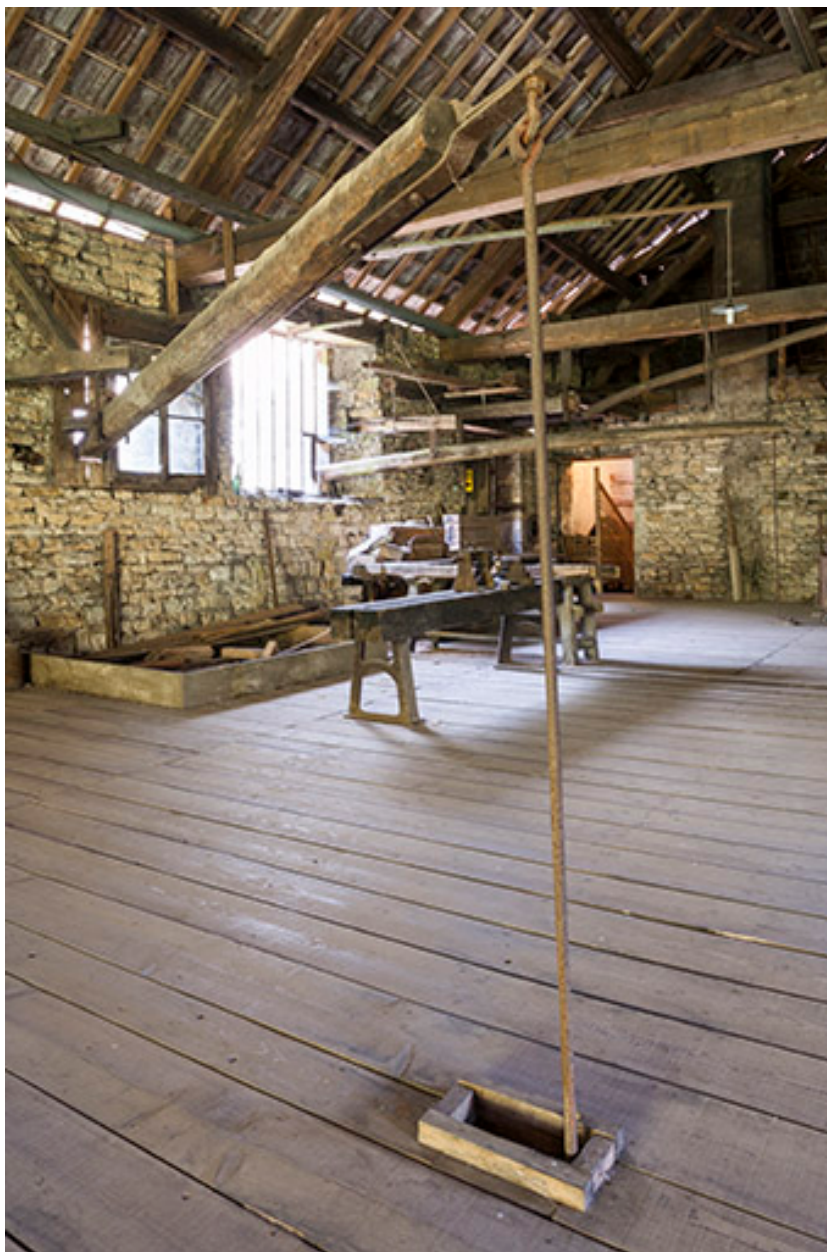
Système de commande pour l'admission de l'eau sur la roue (est) des martinets.
