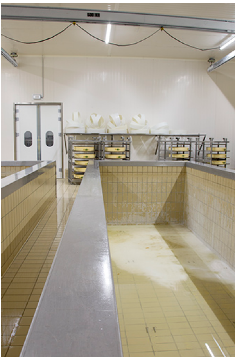
Atelier de saumurage : bac vide.
