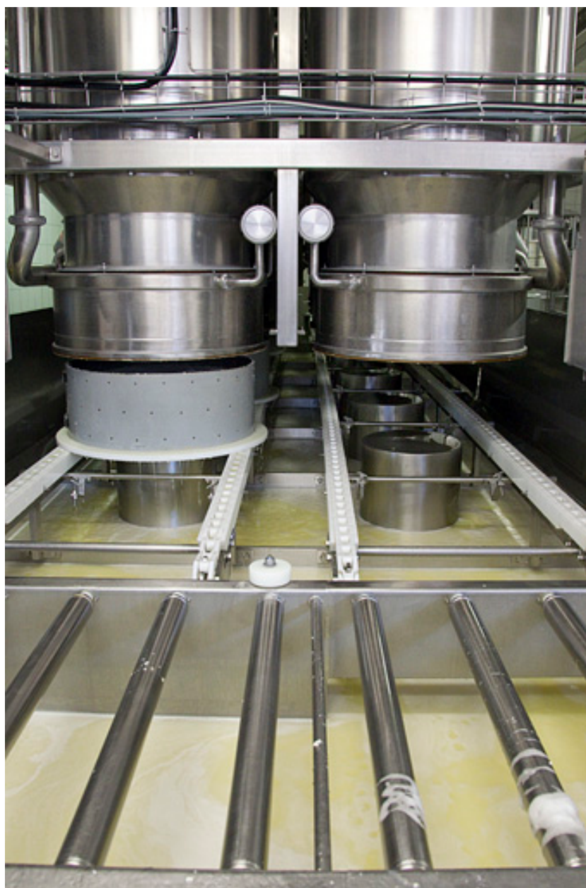
Fabrication du comté : installation de soutirage (cloches et moule).
