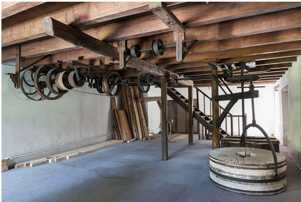
Premier étage. Transmission par poulies et meules.
