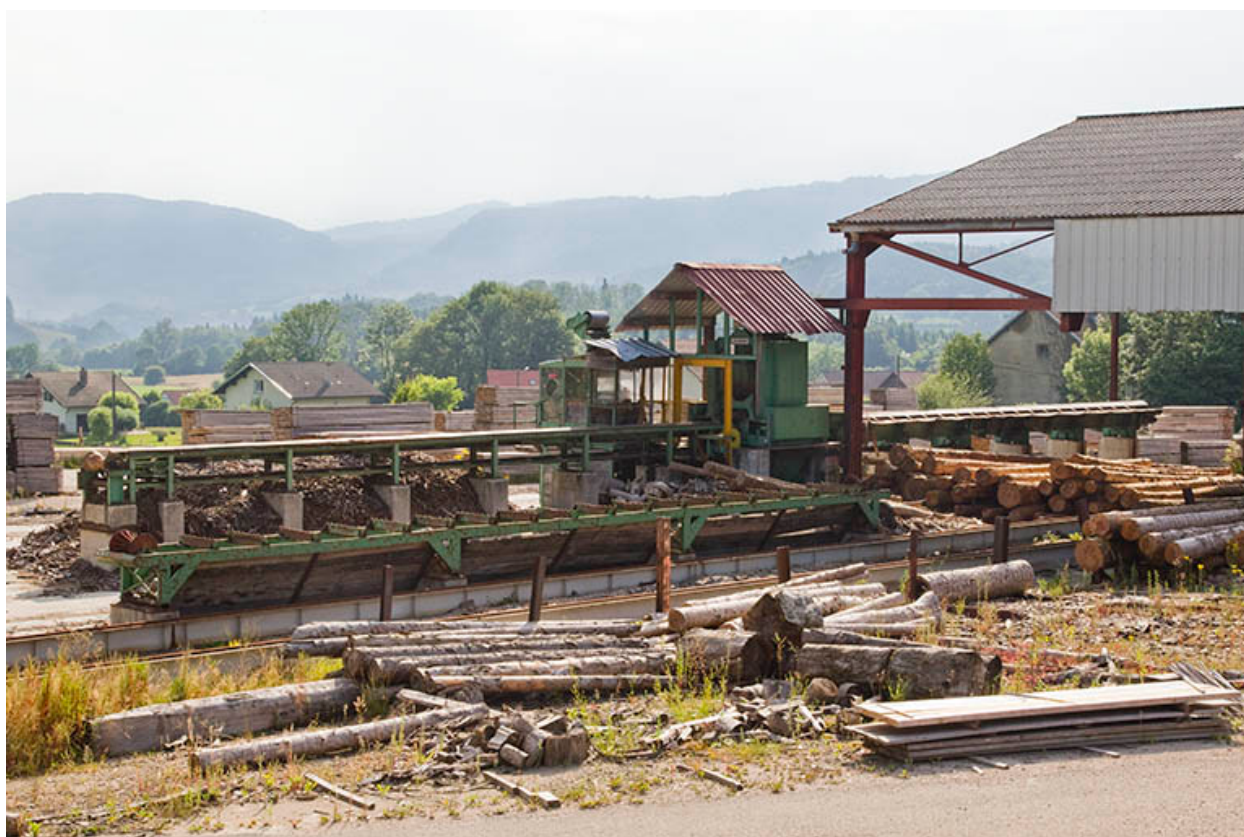
Parc aux grumes : convoyeur et écorceuse Segem.
