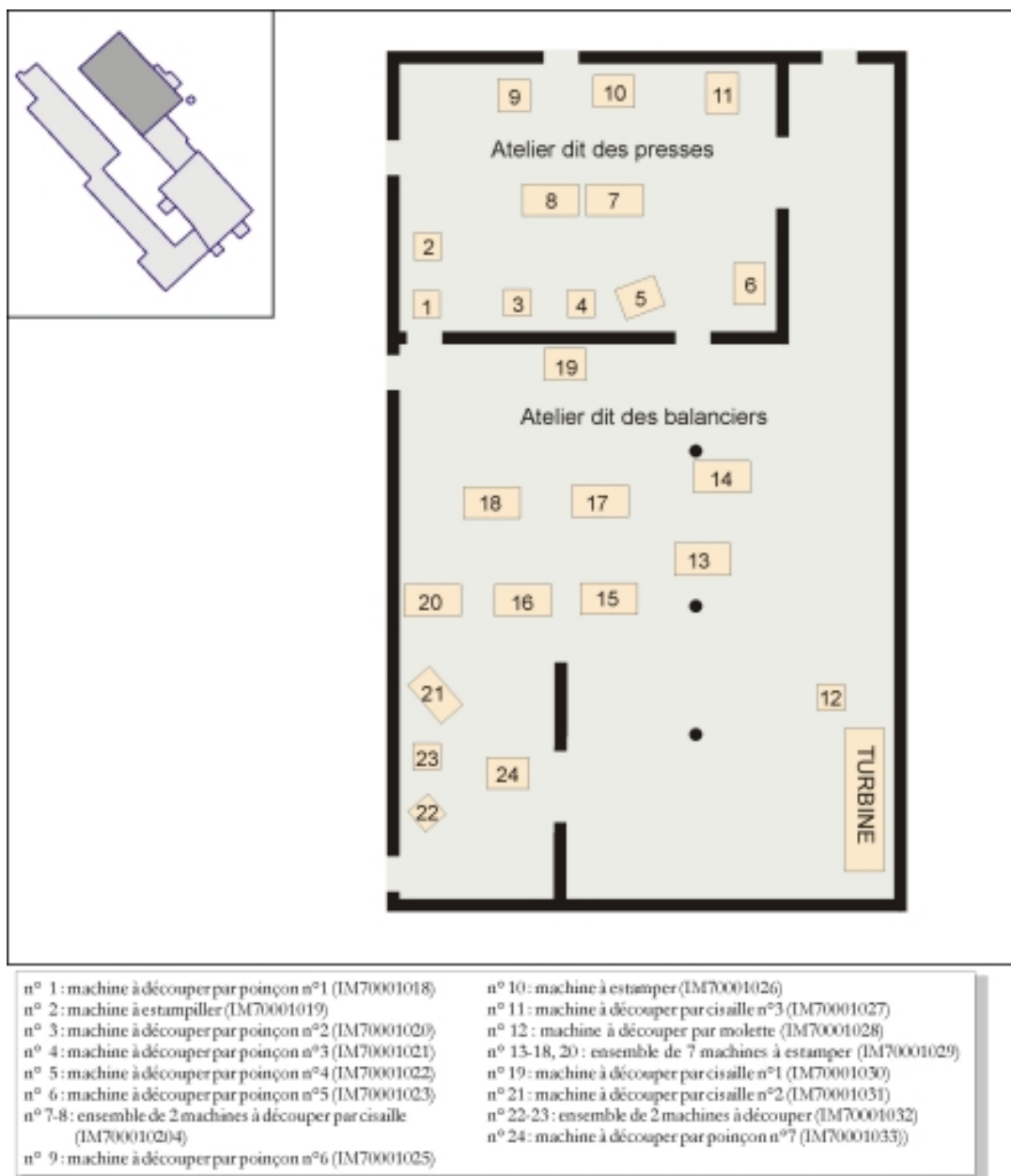
Plan de localisation des machines de la ligne de fabrication des outils non forgés.
