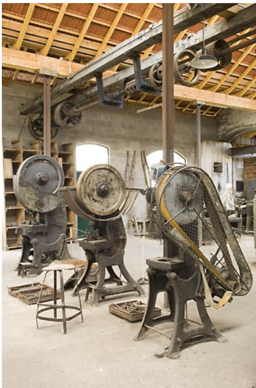
Atelier ouest. Presses "col de cygne".
