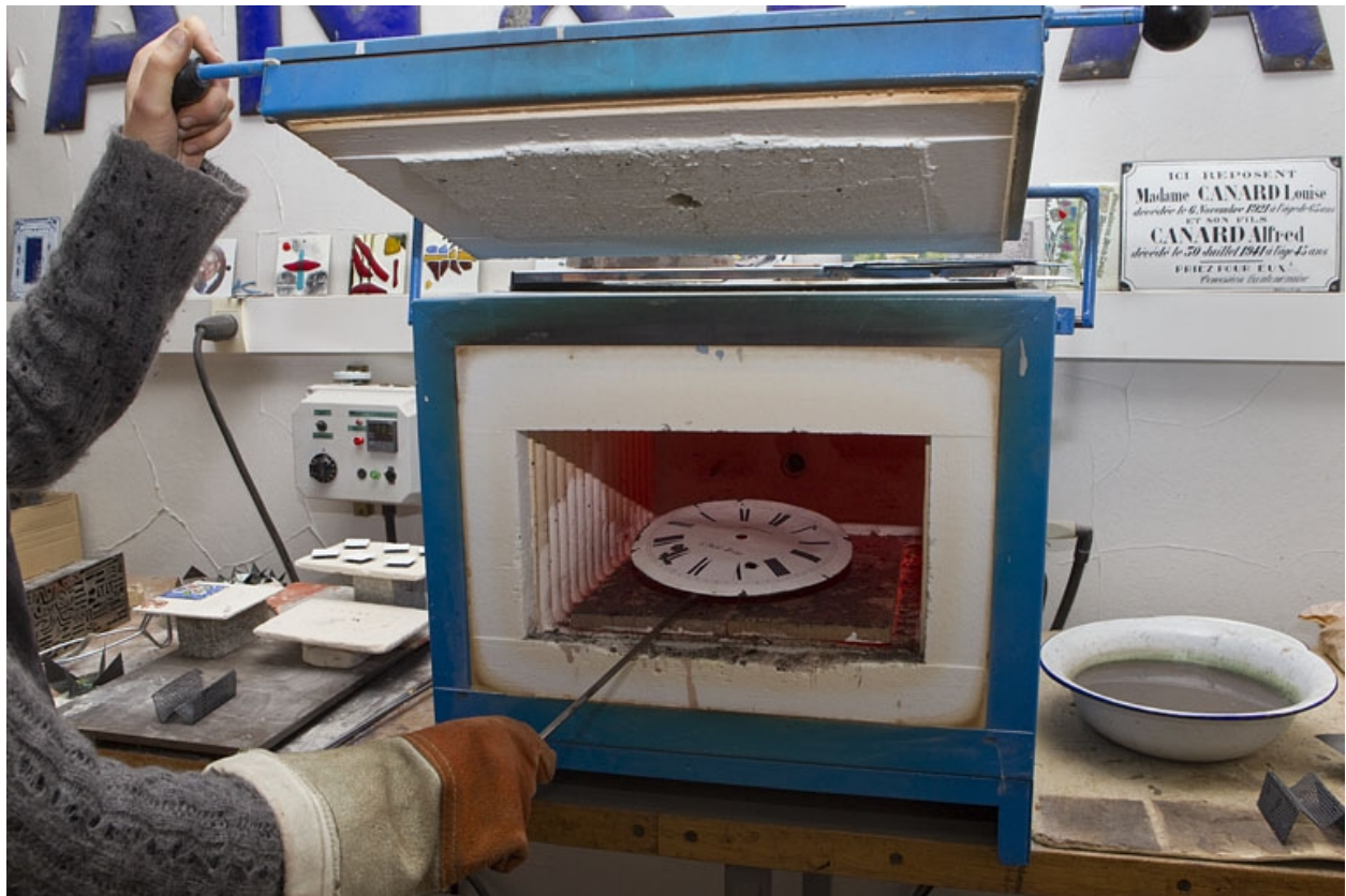
Enfournement d'un cadran émaillé : le four.
