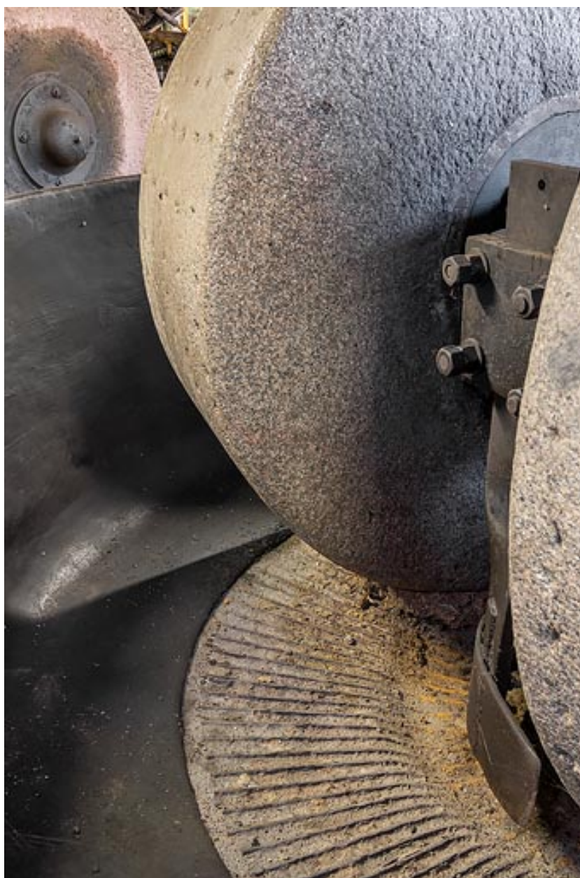
Défibreuse : détail des meules.
