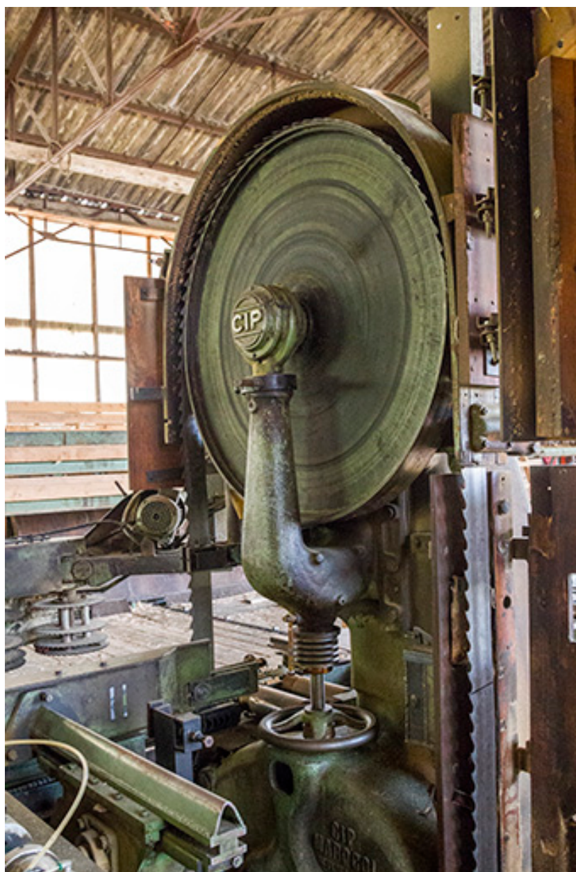
Atelier de fabrication de 1953 : volant et lame de la scie CIP Marqcol (détail).
