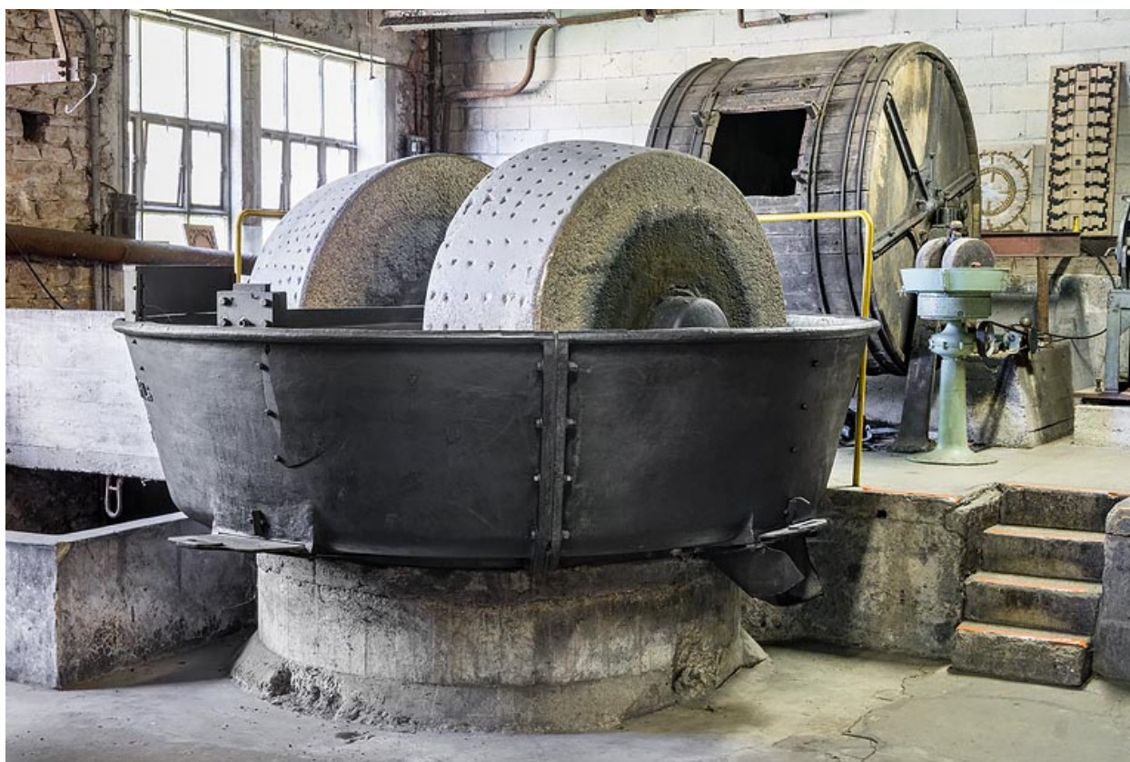
Usine à papier et cartonnerie dite manufacture de carton-cuir Hétier, Mesnay : défibreuse Lamort.
