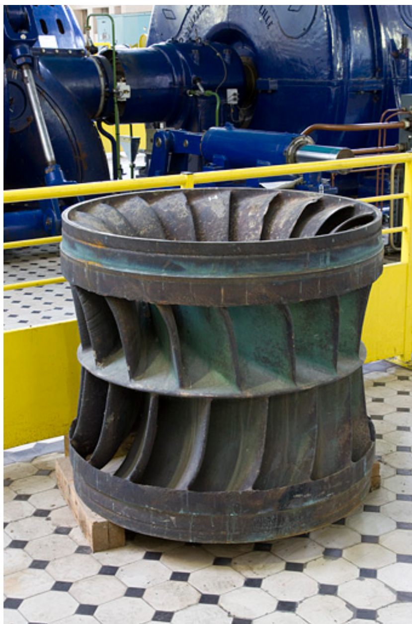
Roue d'une turbine Francis double.
