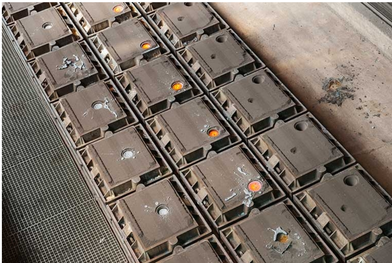
Ligne de moulage. Détail des moules (2).
