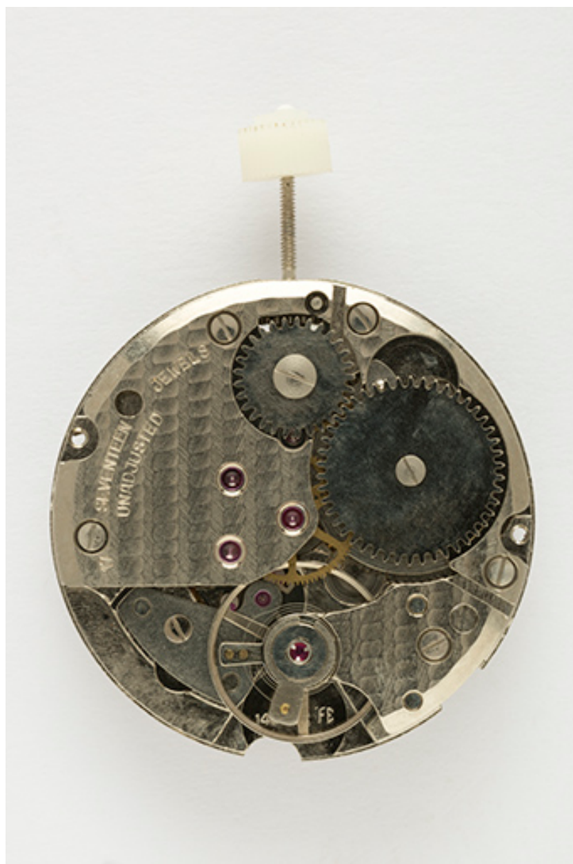
Mouvement de montre mécanique France Ebauches FE 140-C (côté ponts).
