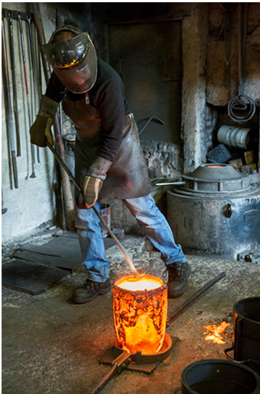
Poche de bronze en fusion. L'opérateur retire le laitier (scories) (2).
