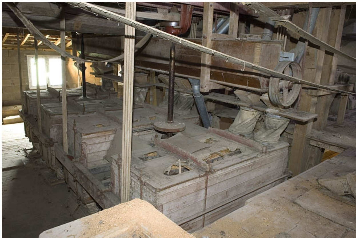
Vue plongeante sur les plansichters (3e étage).
