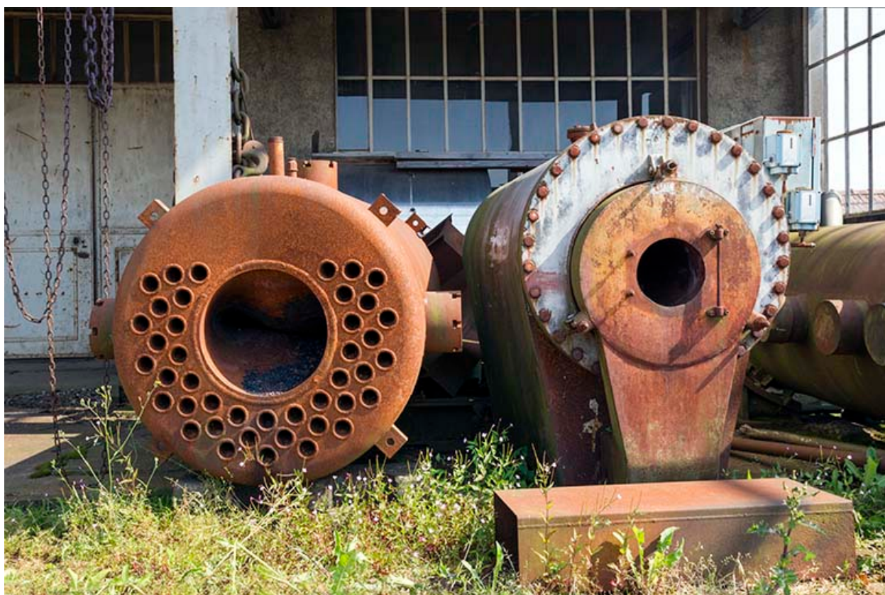
Site rue du Contremont : chaudières à vapeur.
