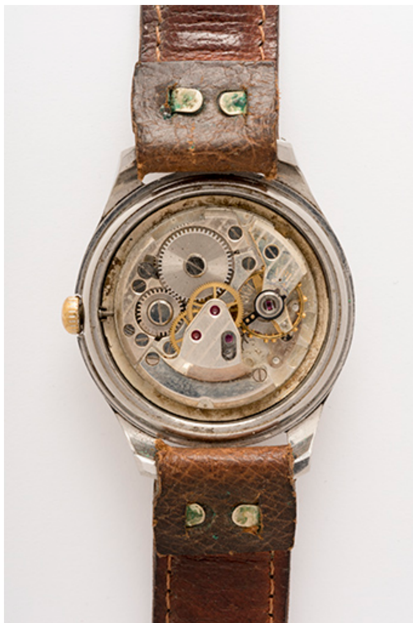
Montre-bracelet mécanique Manufrance : mouvement Parrenin HP 901.
