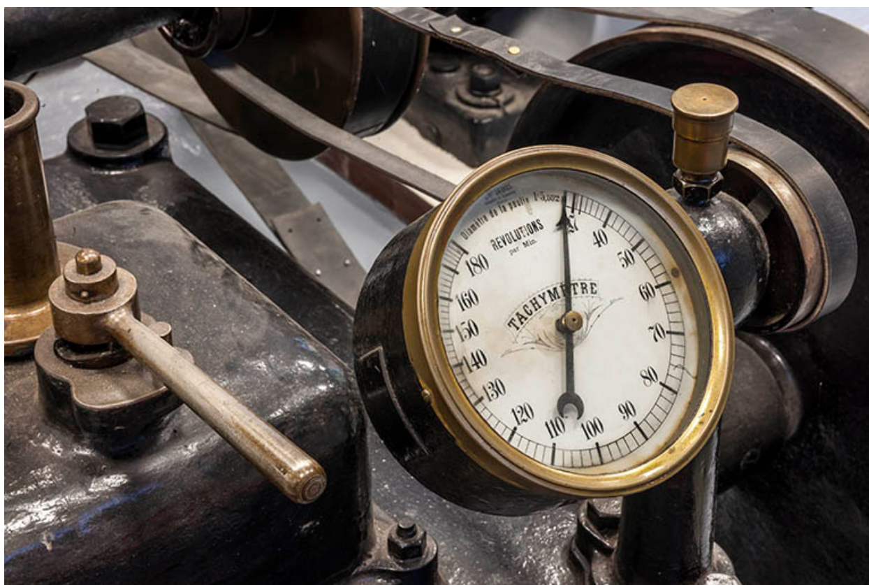
Tachymètre (compte-tours) du régulateur SACM.
