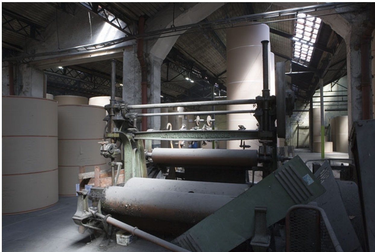
Magasin industriel. Bobineuse Neyret-Brenier.
