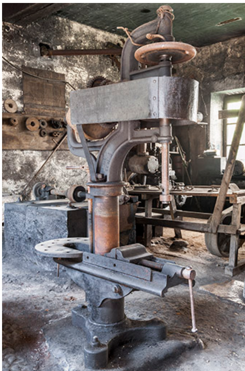
Atelier de mécanique. Perceuse à colonne.
