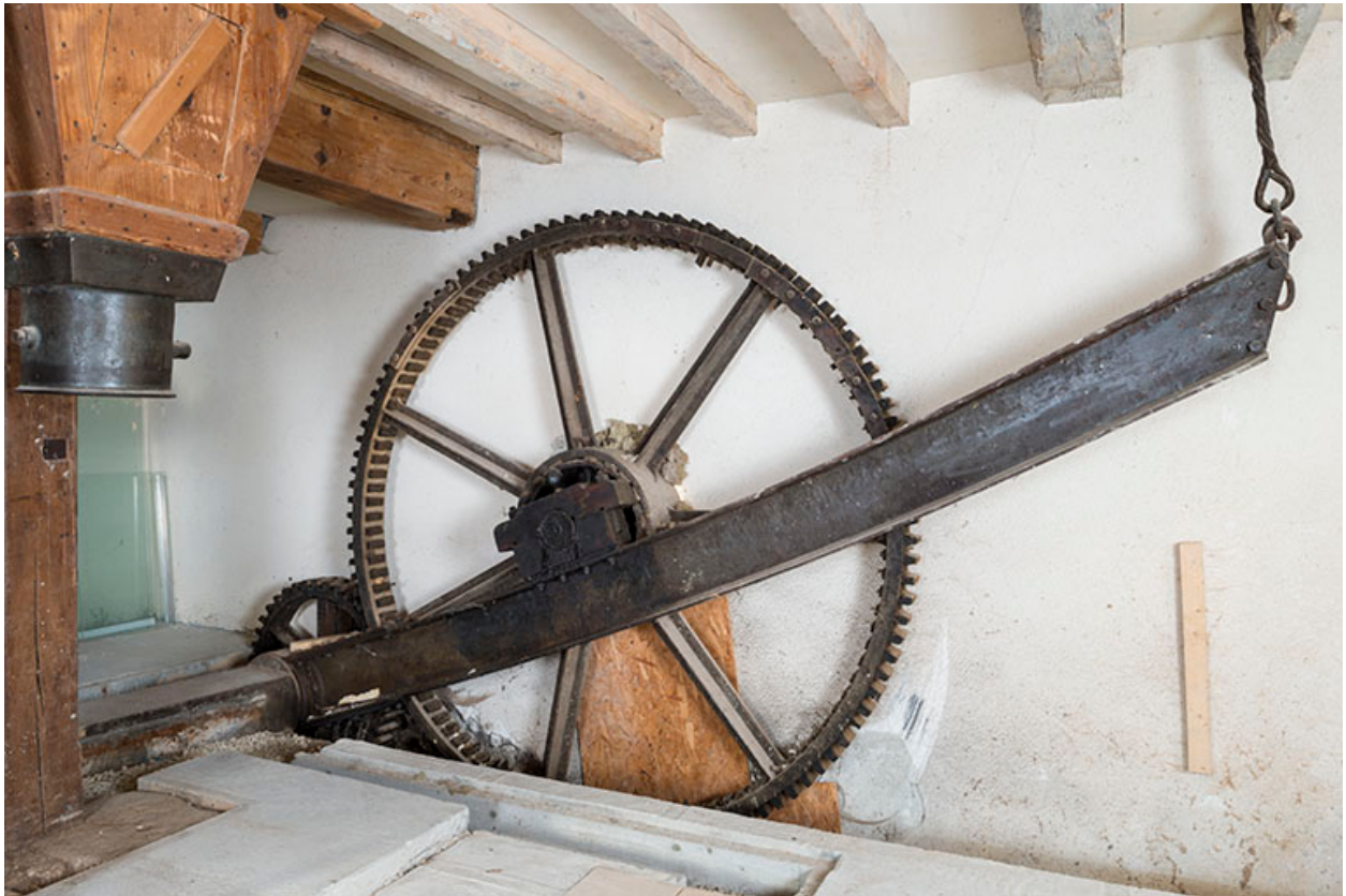
Système de levage de la roue suspendue (amont) : volant engrené (axe de la roue) et levier.
