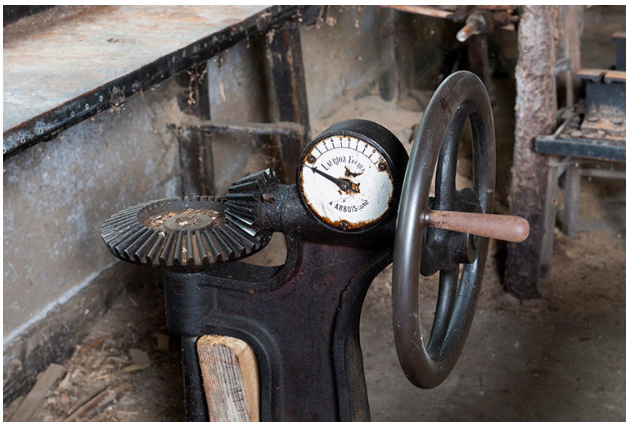
Usine : commande de la turbine Laurioz.
