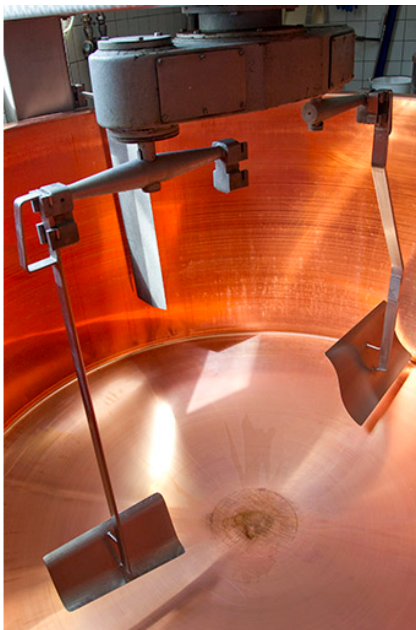
Cuve de fabrication : outils de brassage.
