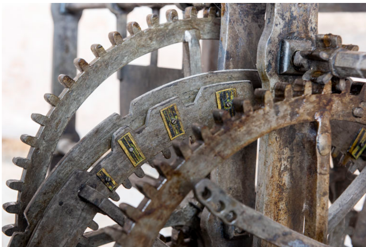
Corps arrière droit (sonnerie des quarts d'heure) : détail de la roue de compte.
