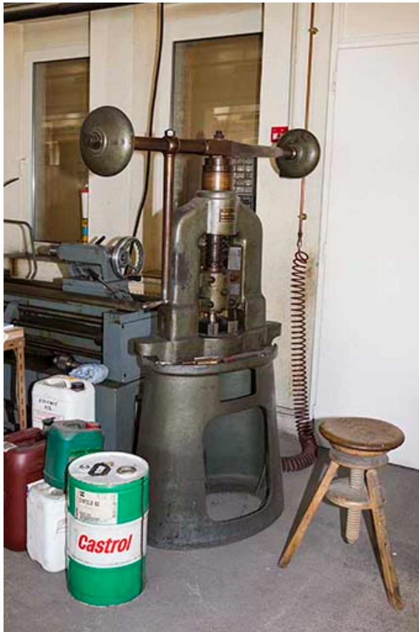
Usine, rez-de-chaussée : grosse presse à balancier.
