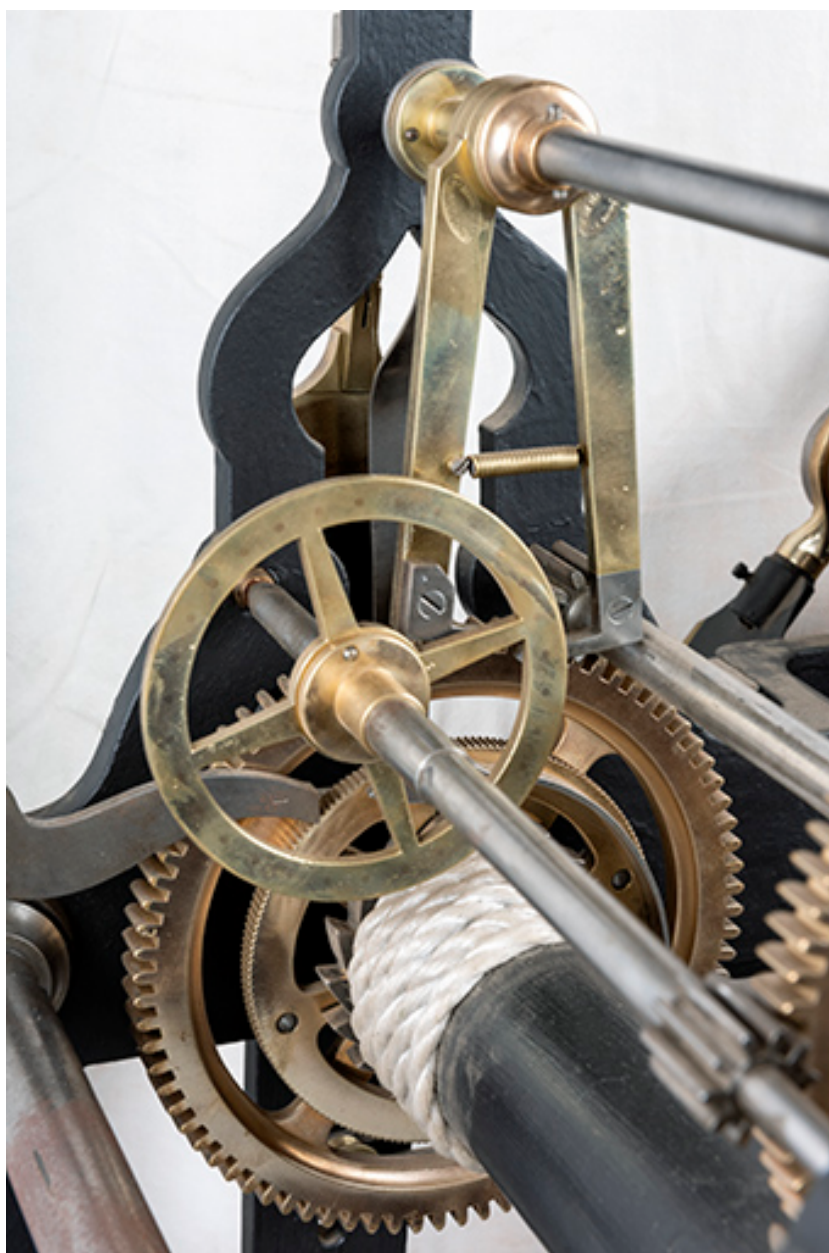
Mouvement, mécanisme des heures : échappement à chevilles et tambour moteur.
