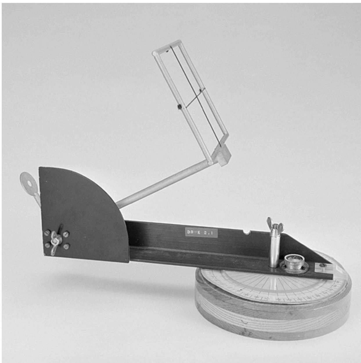
Vue latérale gauche de la mire avec niveau circulaire.
