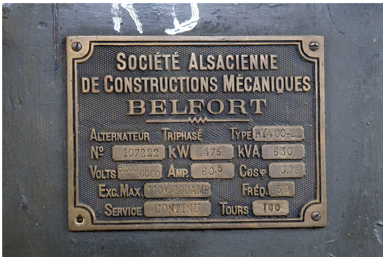
Plaque de constructeur d'un alternateur SACM.
