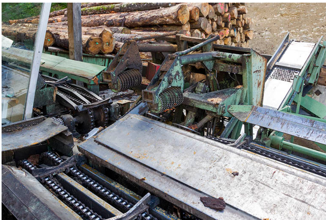
Installation de billonnage.
