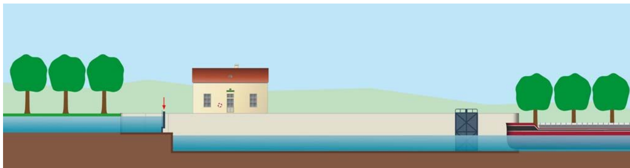
Schéma d'éclusage d'un bateau montant, étape 2.
