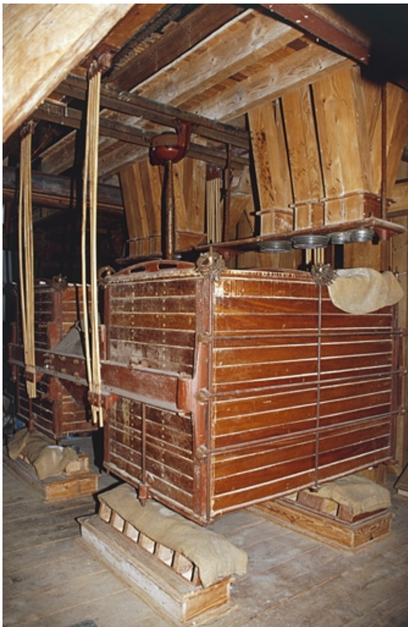
Plansichter Lafon à l'étage en surcroît.
