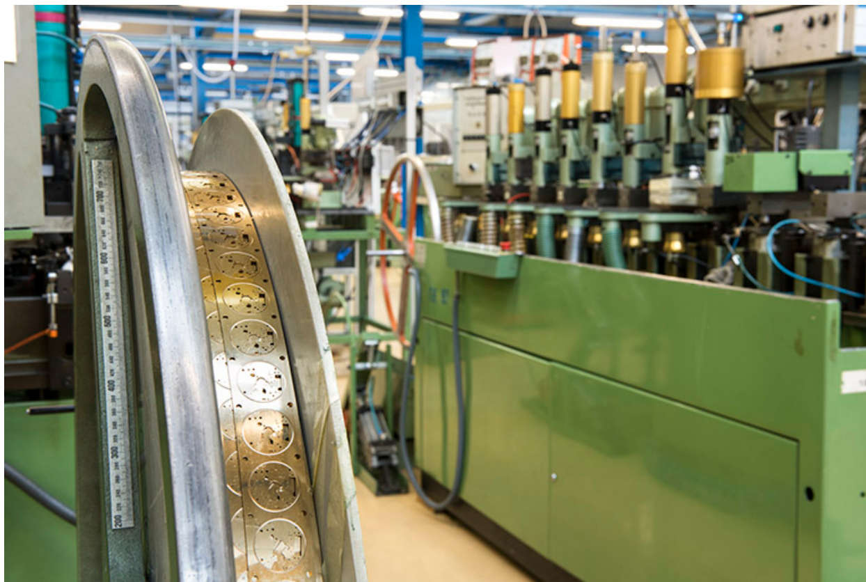
Atelier d'usinage : bande de laiton usinée.
