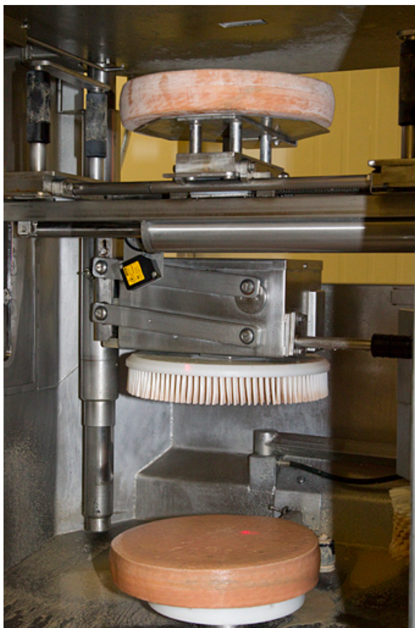
Fabrication du morbier : zone de travail du robot de soins, avec deux meules en place.
