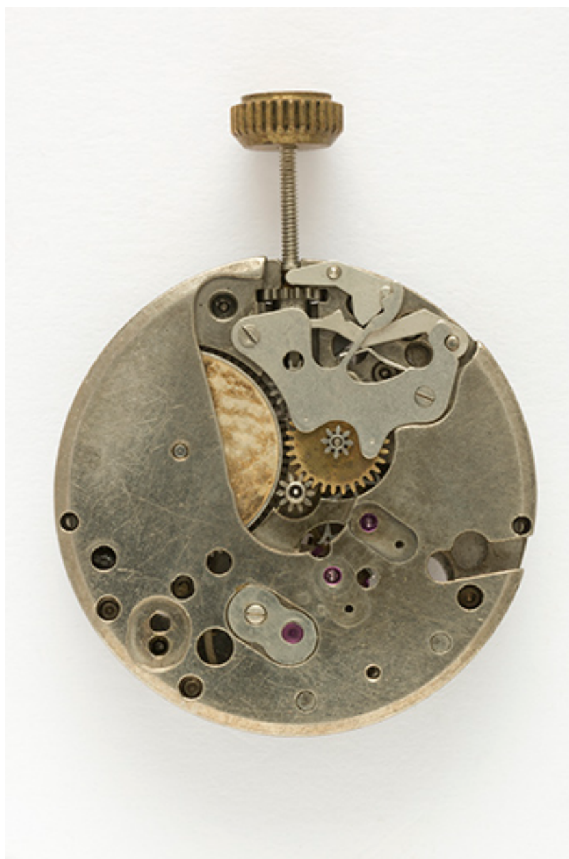
Mouvement Parrenin HP 90 : face côté cadran.
