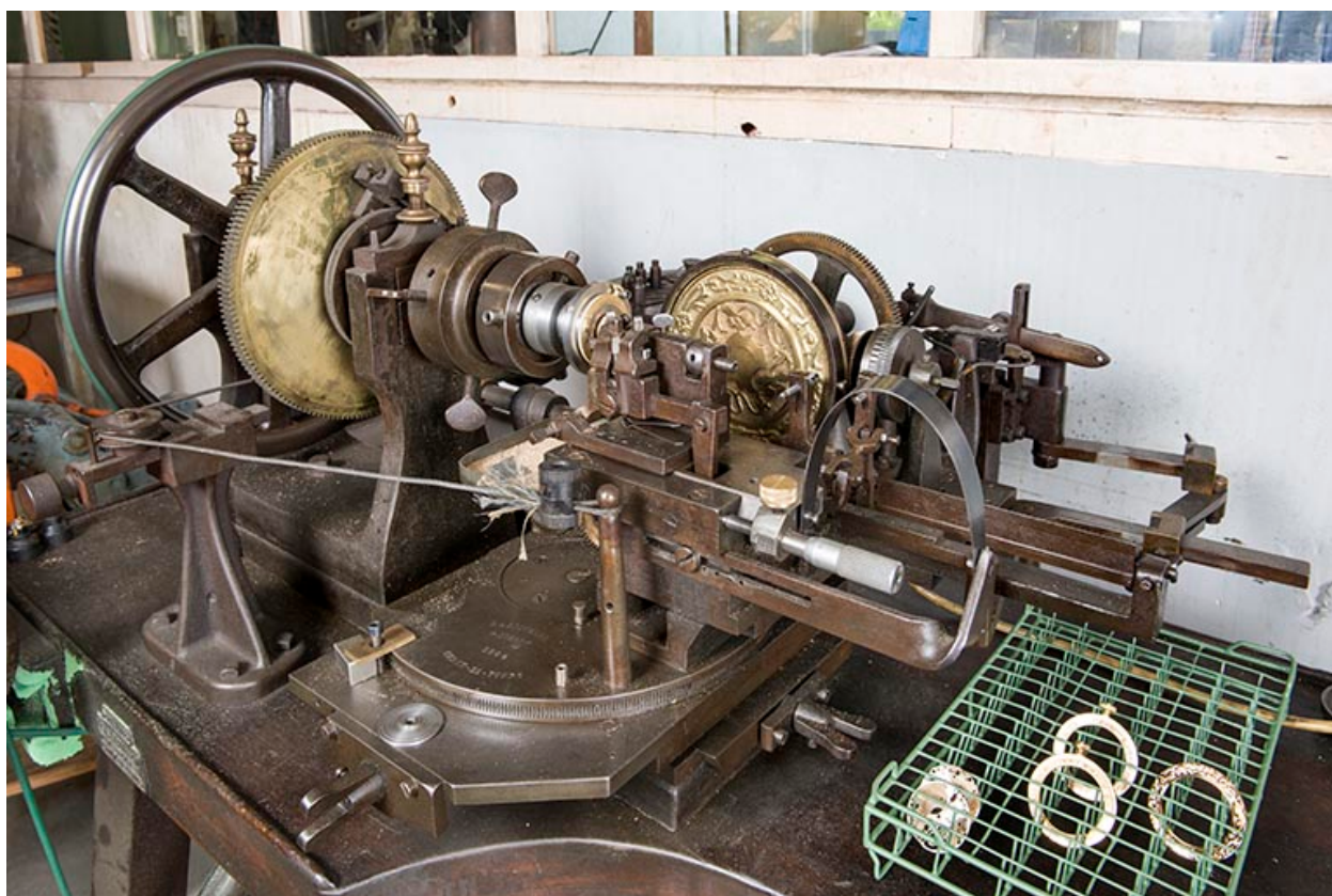
Machine à graver (machine à guillocher), par Lienhard à La Chaux-de-Fonds, 1904.
