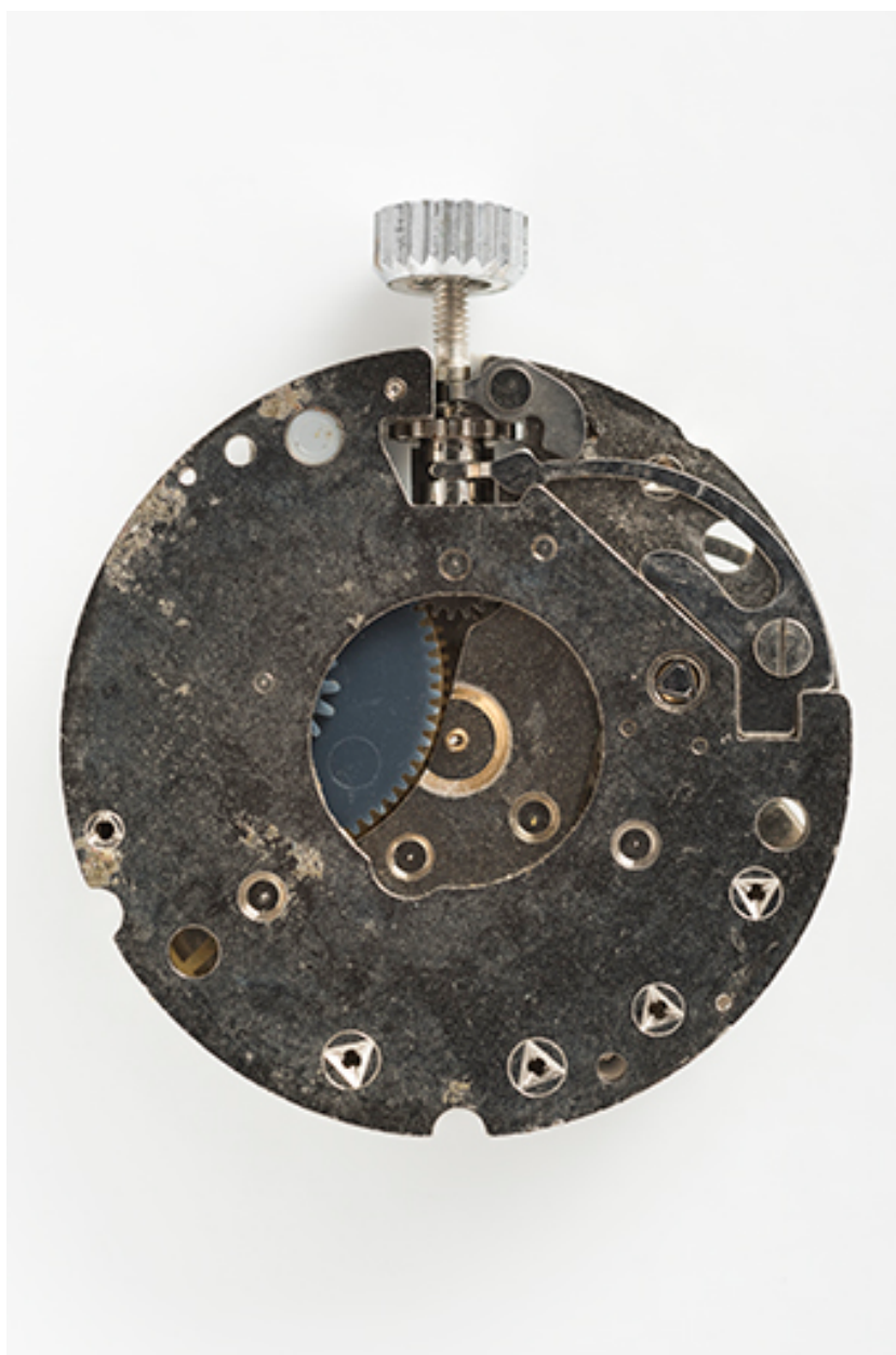
Mouvement Parrenin HP 740 : face côté cadran.
