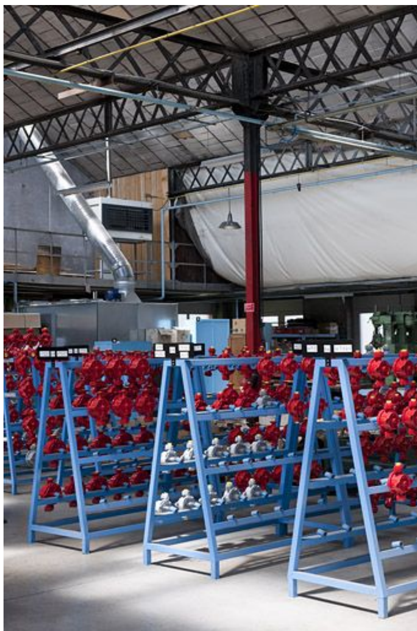
Atelier de fabrication. Portiques de séchage des corps de pompes.
