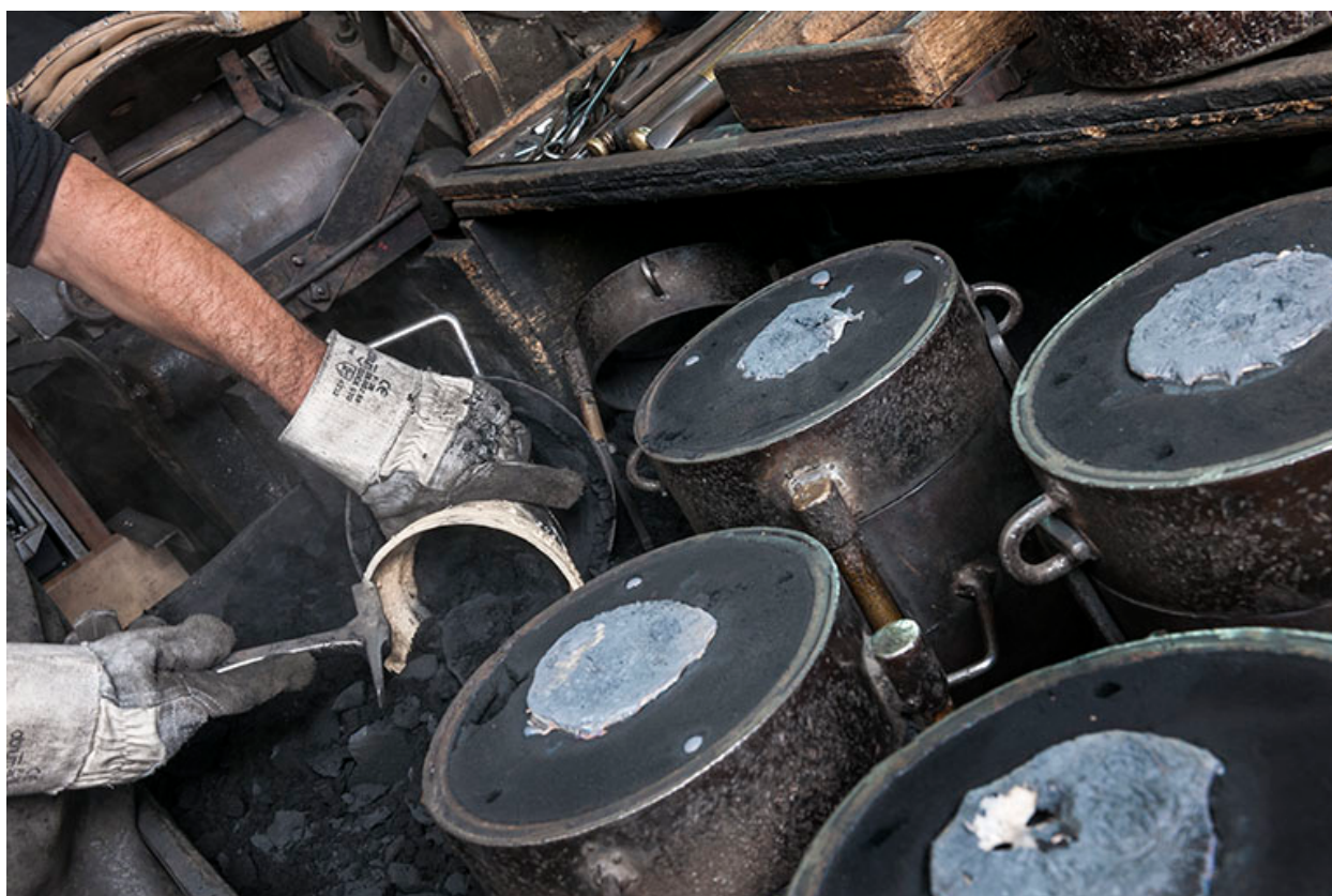
Démoulage. Extraction de la cloche (1).
